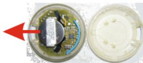
Verwenden Sie ausschließlich den Batterie Typ: **CR2032 3V**
