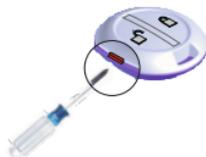
Schieben Sie die Batterie in Pfeilrichtung aus der Batteriehalterung heraus und ersetzen Sie diese gegen eine Neue.
