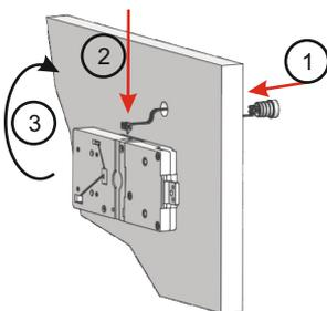
(1) Optische Anzeige mit Kabel von vorne in die Bohrung einpressen. Auf richtige Ausrichtung der optischen Anzeige achten.
