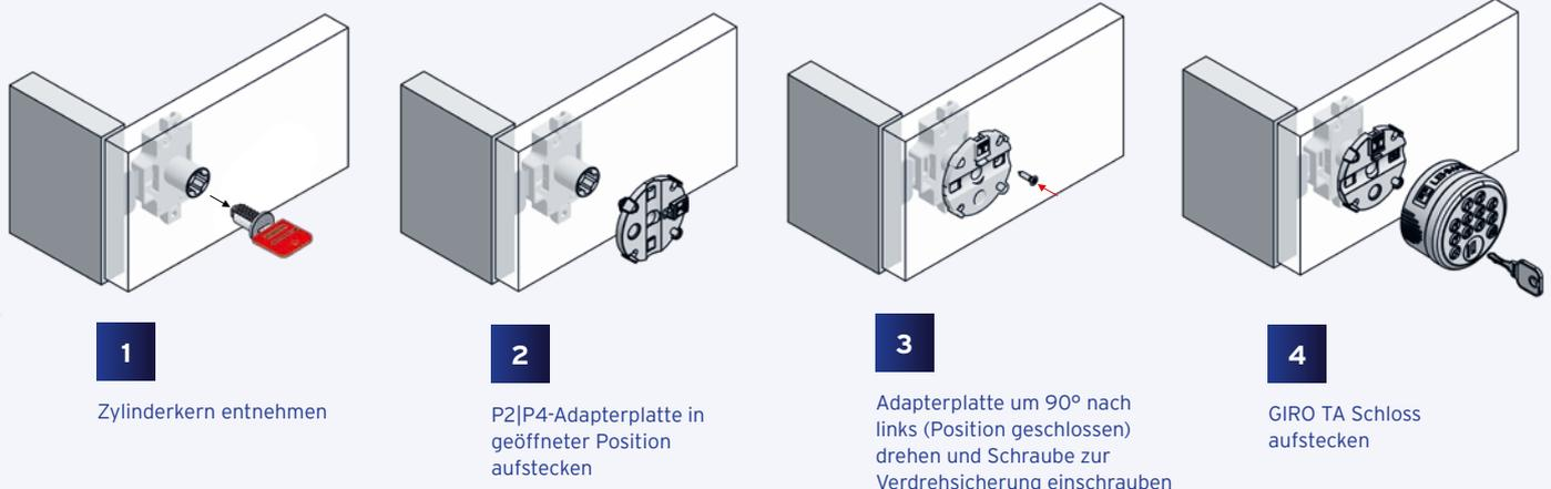
Beispiel zeigt: Retrofitting Prozess beim Aufrüsten eines rechten Schlosses mit 90° Drehwinkel.
