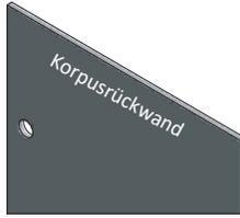
Korpusrückwand mit 12mm Bohrung.
